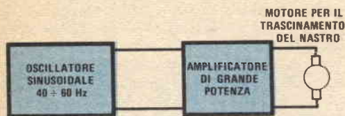
Fig. 1 - Con un oscillatore ad onda sinusoidale ed un amplificatore, è possibile regolare la velocità di un motore per registratore a nastro.
